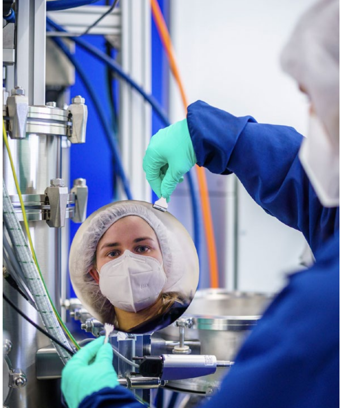
Eine Wissenschaftlerin bestückt die im ForLab-Projekt angeschaffte PEALD-Anlage der Firma Picosun mit einem zu beschichtenden Silicium-Wafer.
