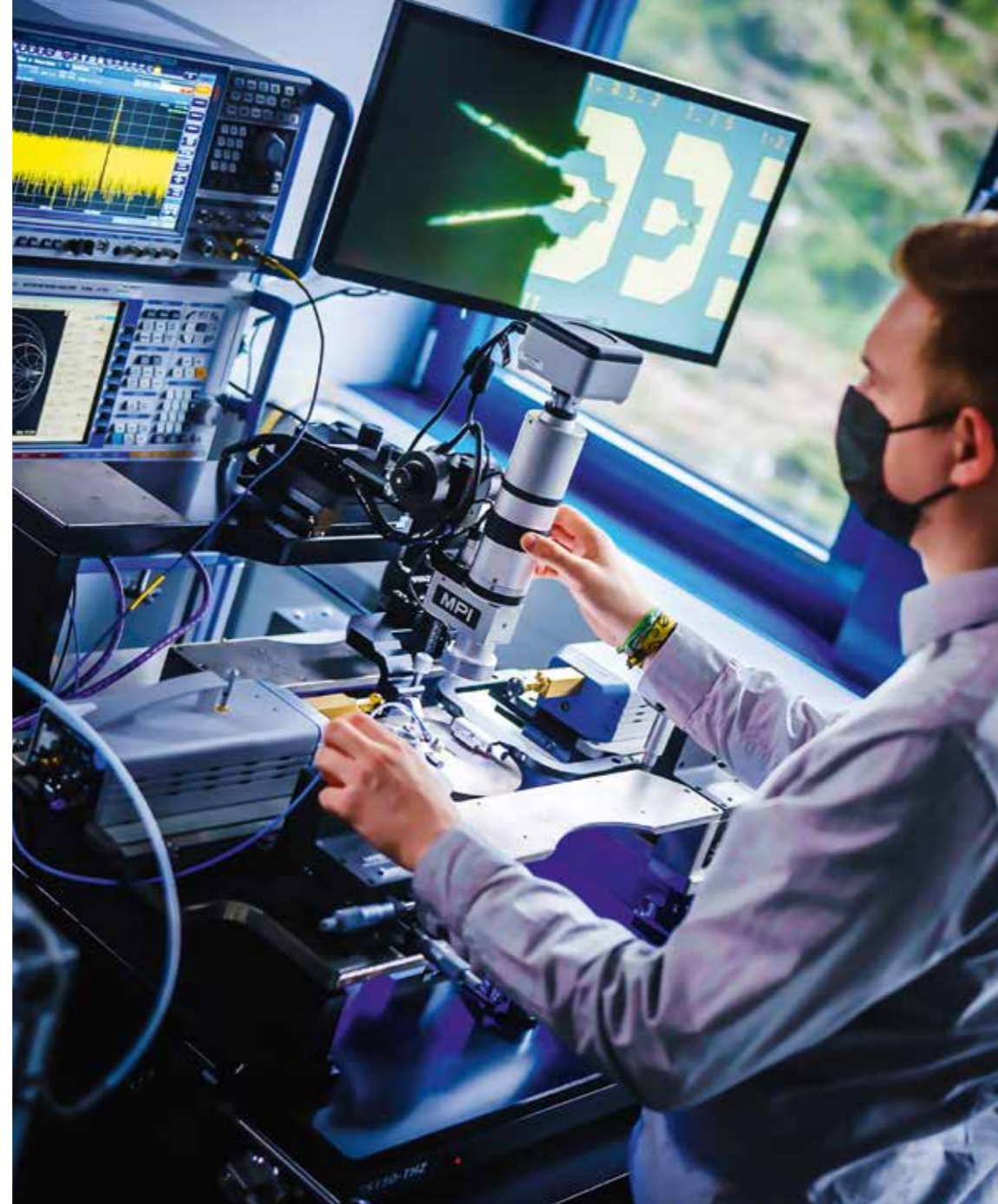
On-Wafer Terahertz Messplatz. Zusätzliche Terahertz-Extender ermöglichen im ForLab SmartBeam Messungen bis 1,5 Terahertz
