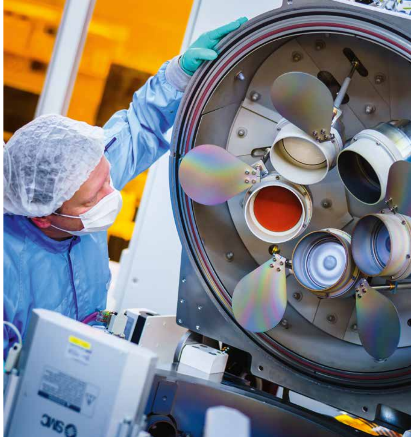
Blick in eine Prozesskammer der im ForLab-Projekt angeschafften Sputter-Clusteranlage, die fünf Targets bereitstellt.
