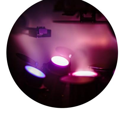
Im Projekt beschaffte Sputteranlage der Firma BesTec die es ermöglicht an der Universität Bielefeld bereits während der Deposition Kennwerte der magnetischen Sensoren zu vermessen. Das Bild zeigt das Cosputtern von drei unterschiedlichen Materialien. Damit kann der Entwicklungsprozess entscheidend verkürzt werden und es lassen sich neue Materialsysteme effizient optimieren
