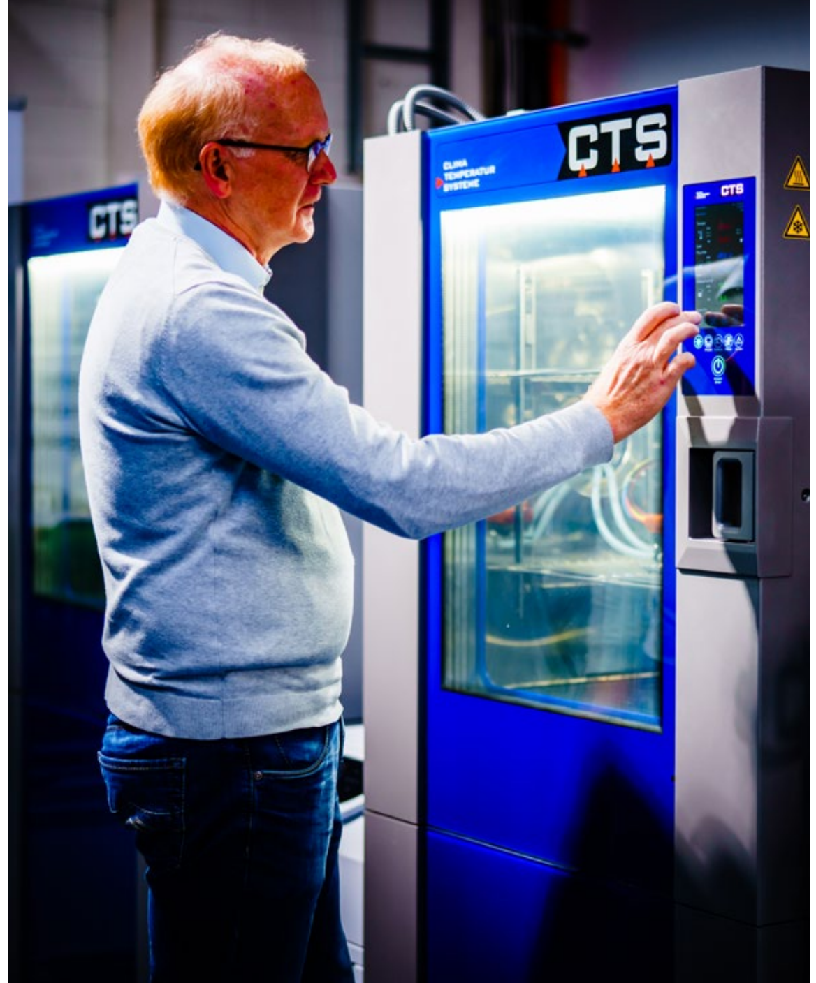
Thermische Analyse von laufenden Demonstrator-Systemen (hier: On-Board Ladewandler) in Klima-Kammern.
