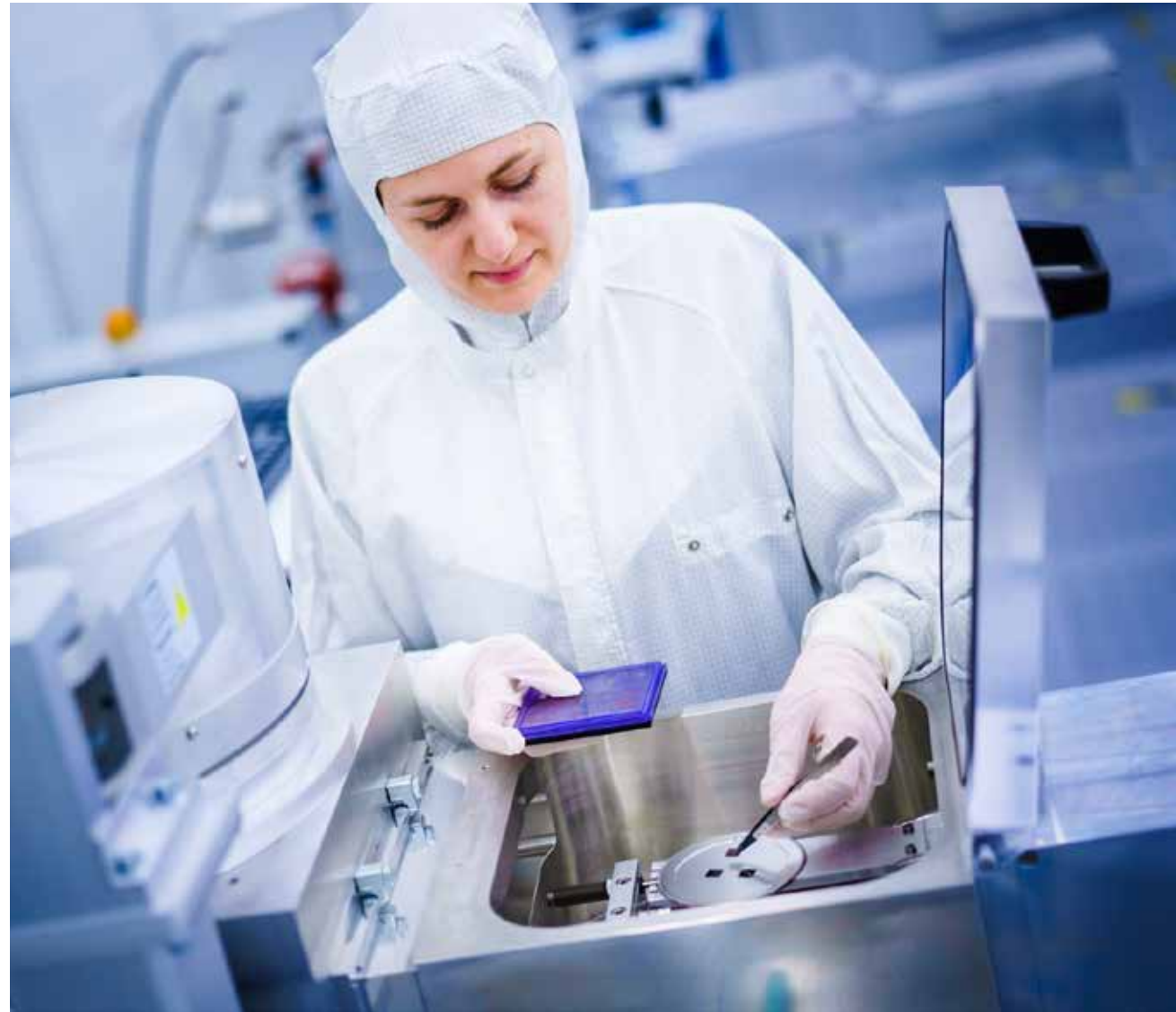
Eine Wissenschaftlerin bereitet die im ForLab-Projekt angeschaffte RIE-Anlage für das Ätzen von III-V Halbleitern vor.
